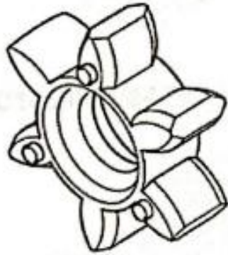
Figura 18. Estrella de goma de acoplamiento elástico para ejes
