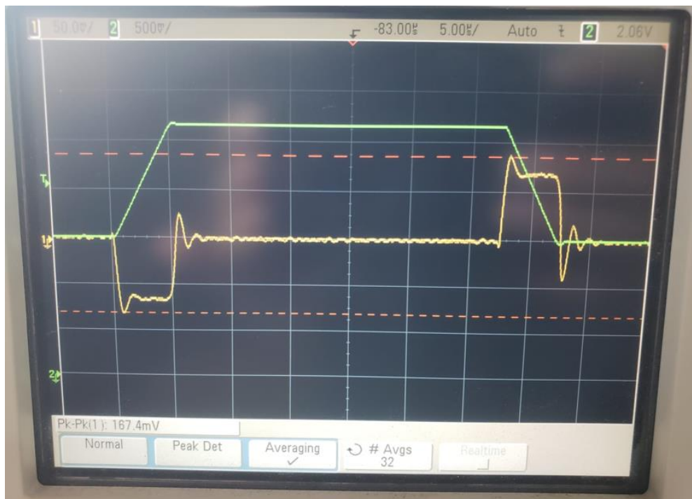
Figura 85: Voltaje de referencia e intensidad de carga en osciloscopio
