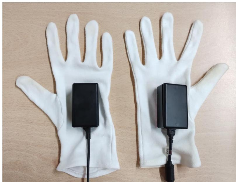
Ilustración 4-3. ESP32 y LSM9DS1 instalados en un guante
