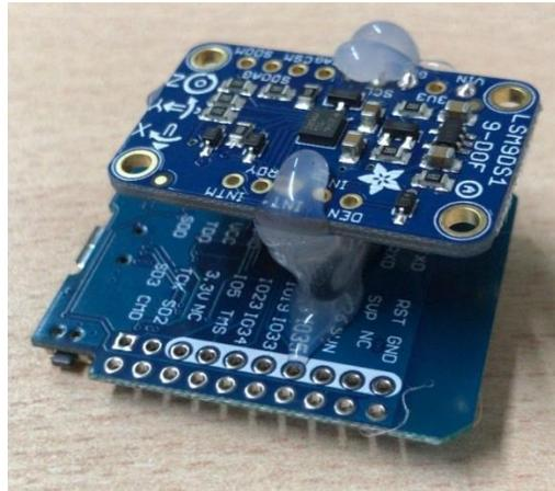
Ilustración 4-2. Conexión entre LSM9DS1 y ESP32
