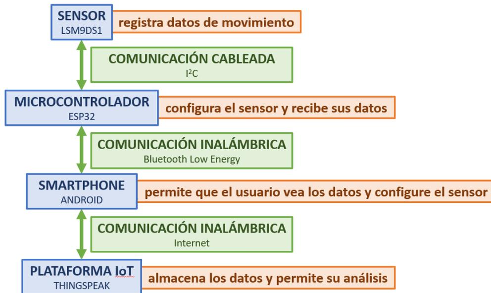
Ilustración 3-1. Flujograma del dispositivo registrador de movimiento
