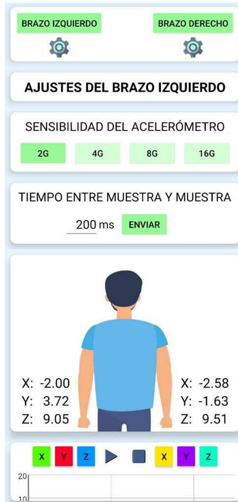
**Ilustración 4-8. Aplicación de Android configurando uno de los ESP32**
