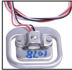
Figura 54. Célula de carga
