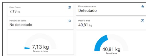
Figura 112. Medida de peso con células de carga
