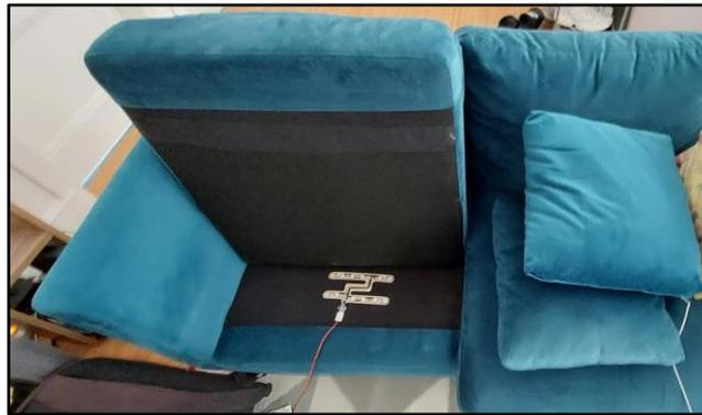
Figura 107. Sensor de presión de asiento situado en sofá
