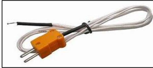
Figura 18. Termopar tipo K
