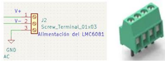
Figura 79. Símbolo y aspecto real del componente J2.
