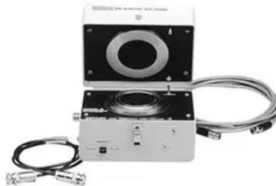
Figura 2. Cámara de resistividad 8009.
