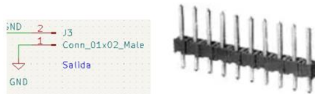
Figura 80. Símbolo del componente J3 y aspecto real de los pines.
