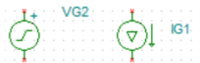
Figura 19. Voltage Generator y Current Generator en TINA-TI.
