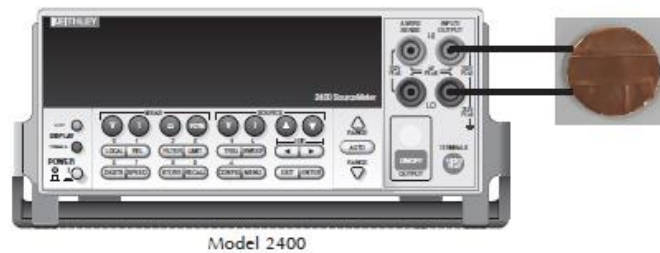
Figura 143. Conexión medida a 2 hilos del Keithley 2400 y la muestra.
