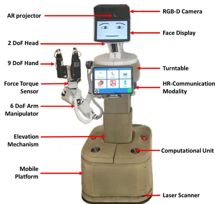
Figura 7. Componentes hardware de RAMCIP.
