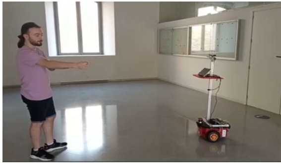
Detección y acercamiento hacia la persona
