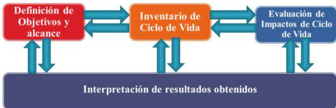
Figura 2. Esquema representativo de las principales fases del Análisis del Ciclo de Vida. Fuente: Elaboración propia
