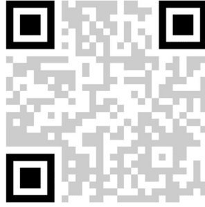
Figura 1. Patrón de detección de posición.
