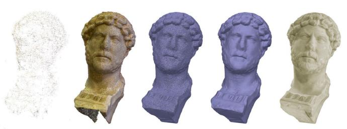
Figura 8. Resumen fases de modelizado. Nube de puntos de enlace, nube de puntos densa, malla alámbrica, malla con superficie y malla texturizada.
