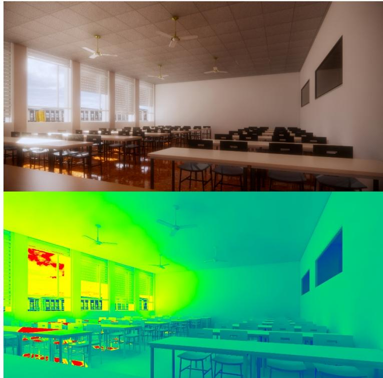
Figura 1 Ejemplo de distintas representaciones de un entorno virtual creado a partir de un espacio real para el análisis de materiales e iluminación, Fuente: elaboración propia
