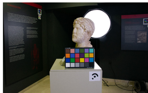
Figura 4. Toma de datos in situ, donde se fotografía la carta de color Colorchecker y uno de los puntos de apoyo y control prediseñados.
