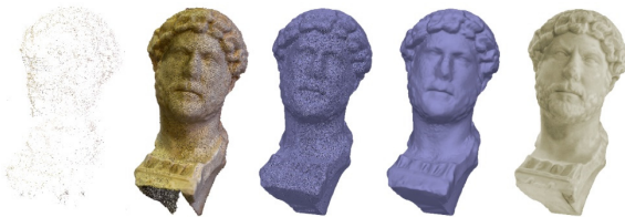
Figura 6. Las diferentes fases de generación del modelo, puntos correlados, puntos densos, elaboración de la triangulación, generación de la superficie y aplicación de la textura.
