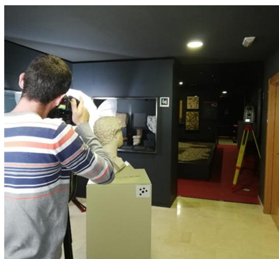
Figura 3. Toma de datos mediante fotogrametría y topografía clásica en el museo arqueológico de Yecla, en marzo de 2020.
