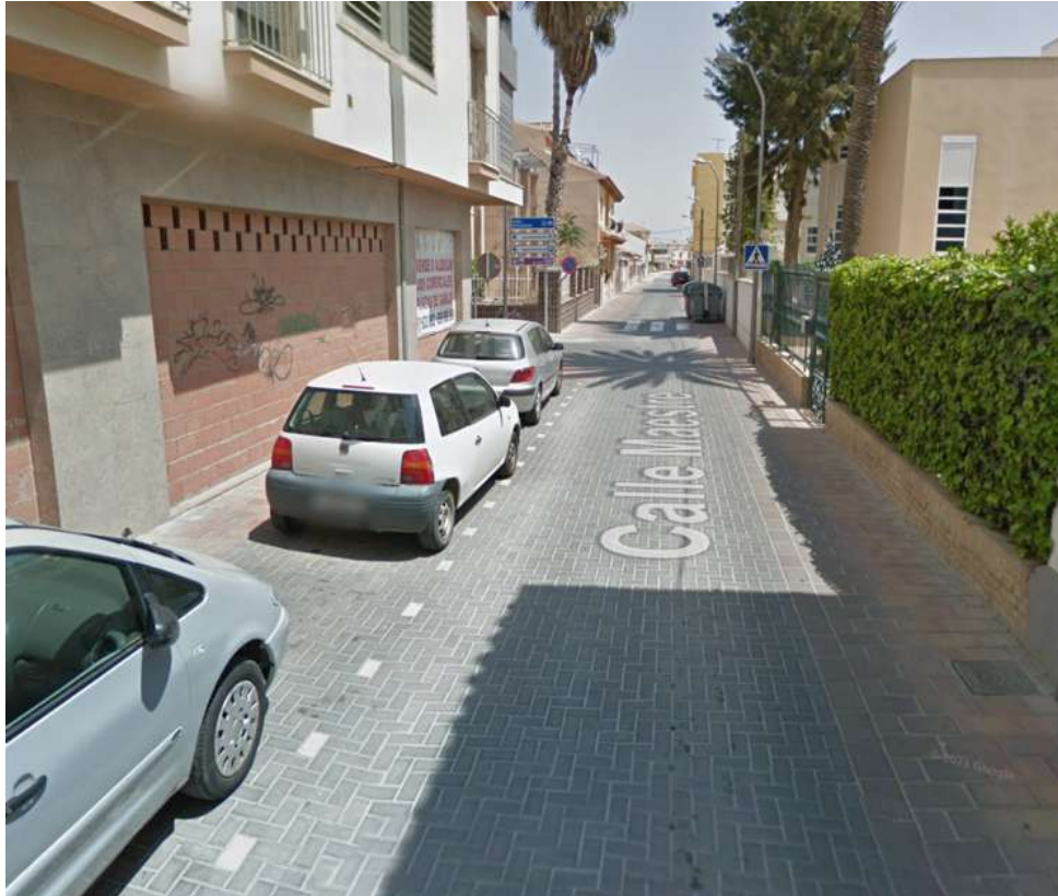
Imagen 7. Calzada, zonas de aparcamiento y aceras en vías menos concurridas a la misma altura. Fuente: Google Earth.
