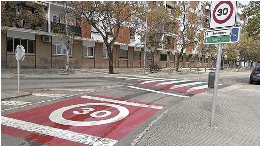
Imagen 9. Señalización al inicio de la zona 30 tanto horizontal como vertical, así como paso de peatones elevado. Fuente: Google Earth.
