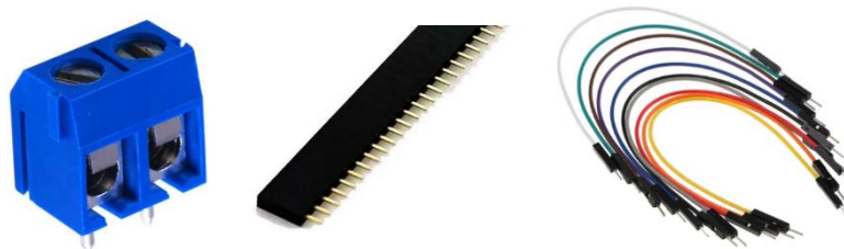
Figura 5.9 Bornera, headers y cables
