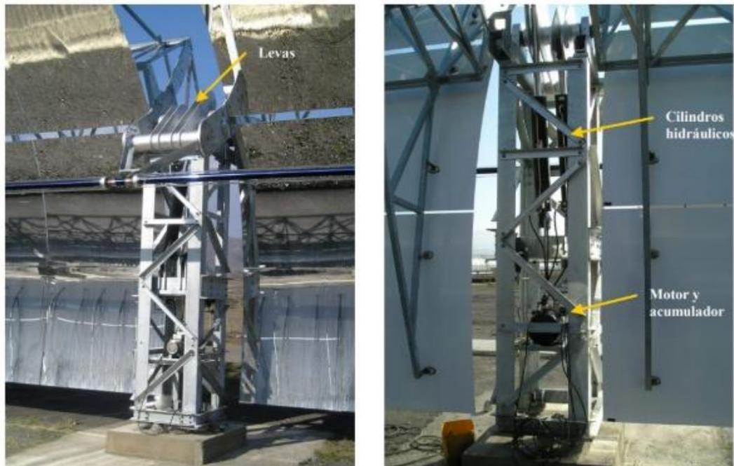
Figura 9.- Unidad hidráulica de seguimiento solar. [12]
