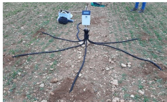
Figura 3. Sensores de humedad instalados en campo de cereales.
