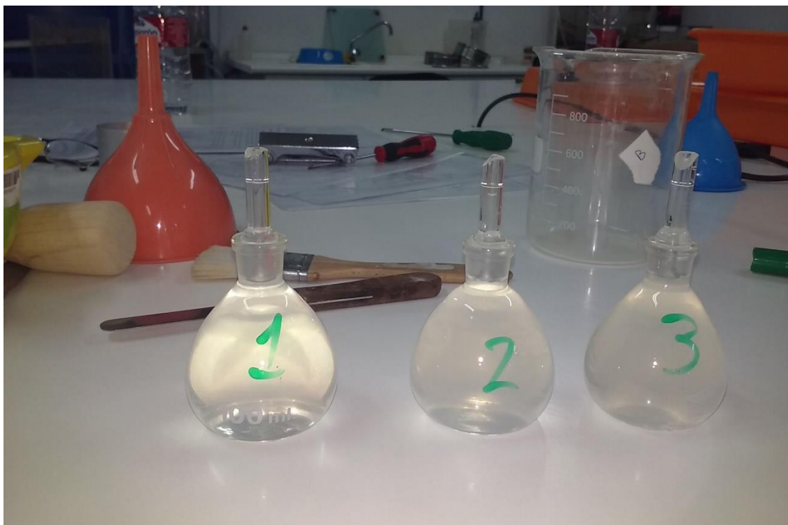
Imagen 4.1. Masa del Picnómetro + Masa de Agua
