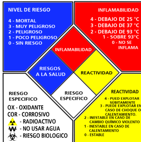
Figura 3. Diamante de peligros NFPA 704
