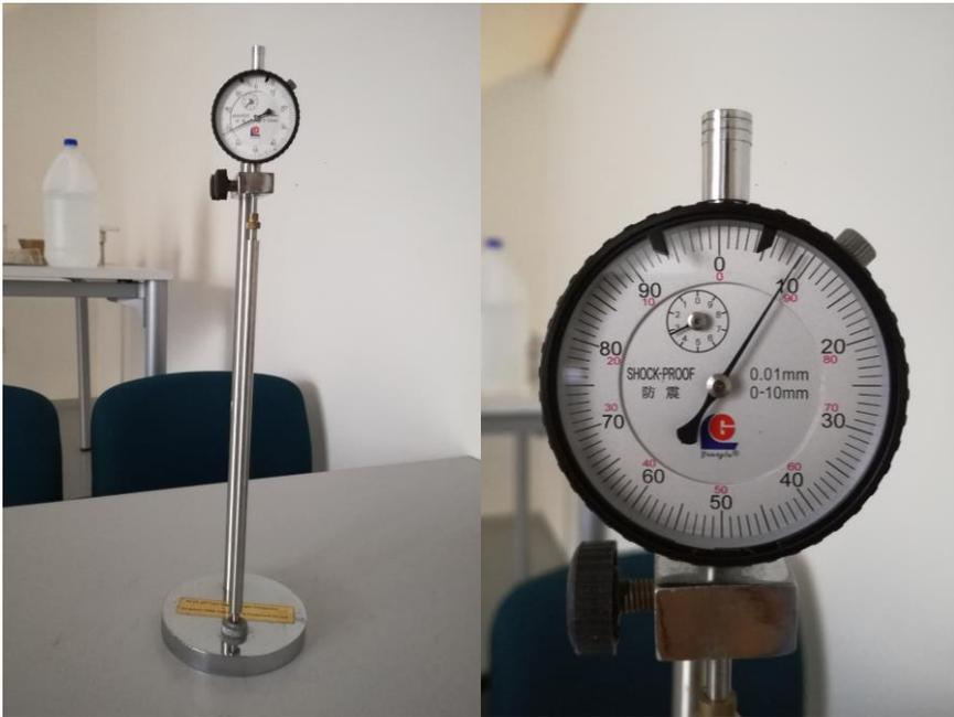
**Figura 5.35 - Galga patrón y comparador analógico del equipo**
