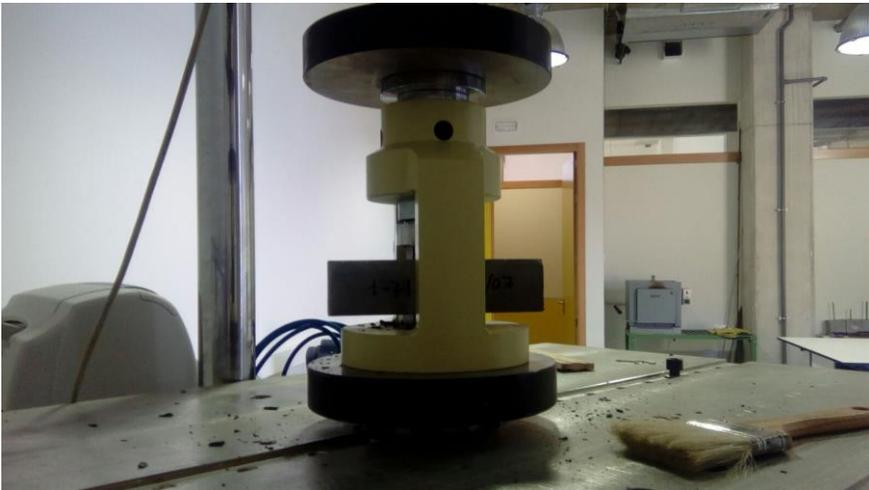
**Figura 5.33 - Prueba de resistencia a compresión de un mortero**
