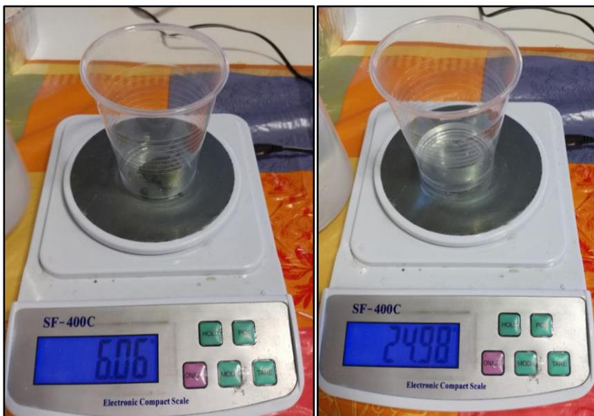
**Figura 5.18 – Cantidades de agua y de muestra utilizadas para el ensayo de medición del pH**
