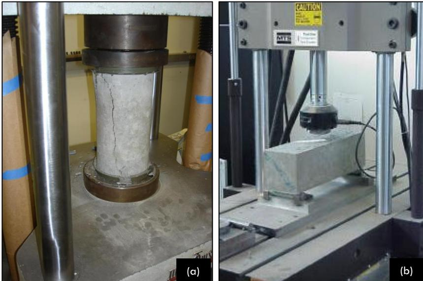
**Figura 2.3 - Ensayos de resistencia a compresión (a) y a flexión (b)**
