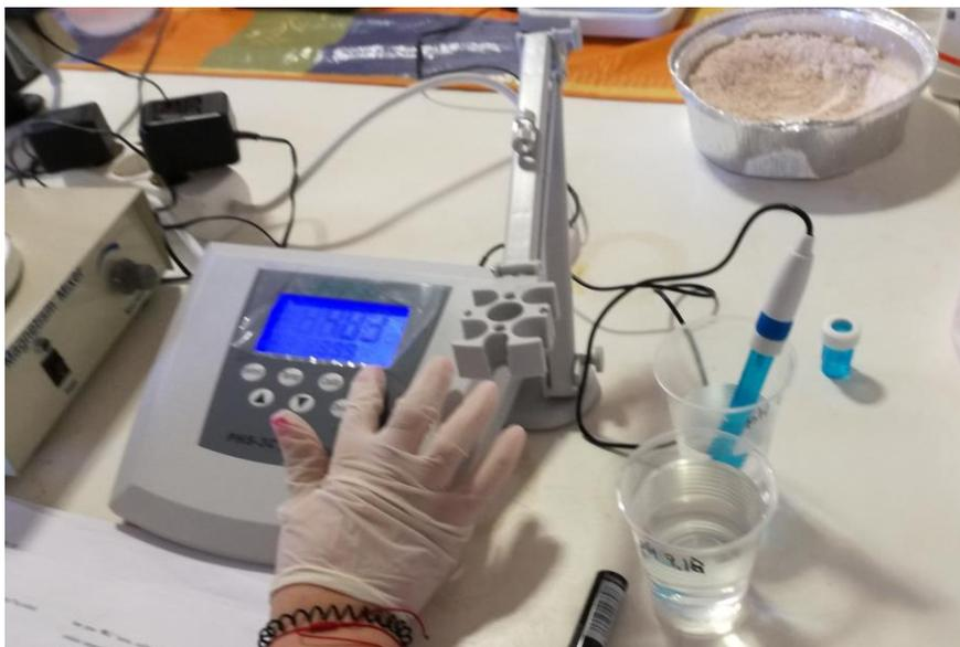
**Figura 5.20 - Calibración del pH-metro**
