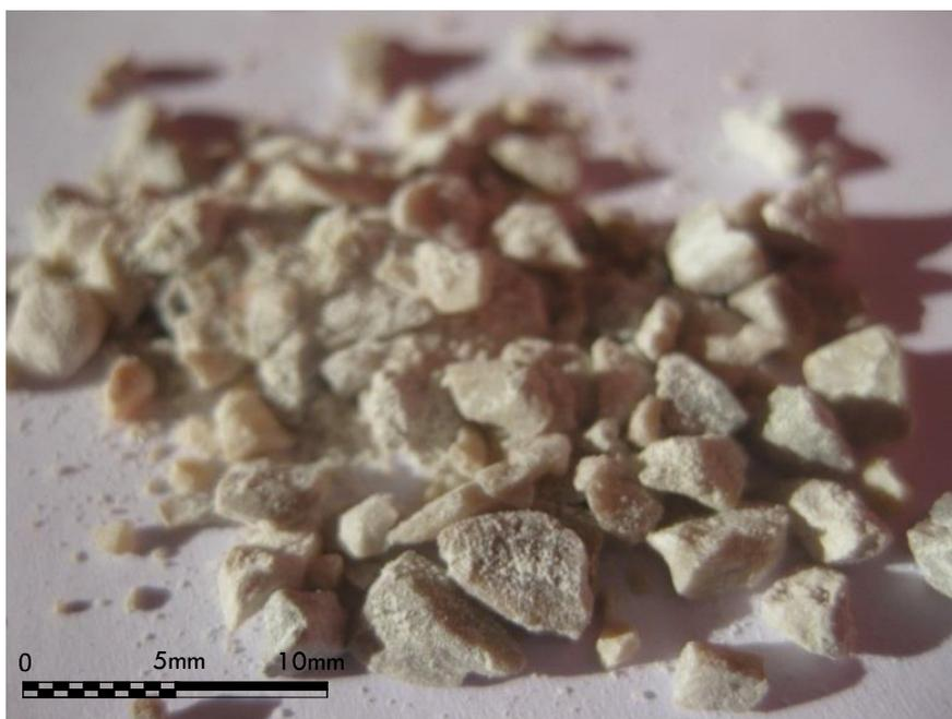
**Figura 5.8 - Micrografía a diferentes escalas del árido calizo (1)**
