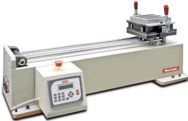
**Figura 5.28 - Compactadora para cementos y morteros**
