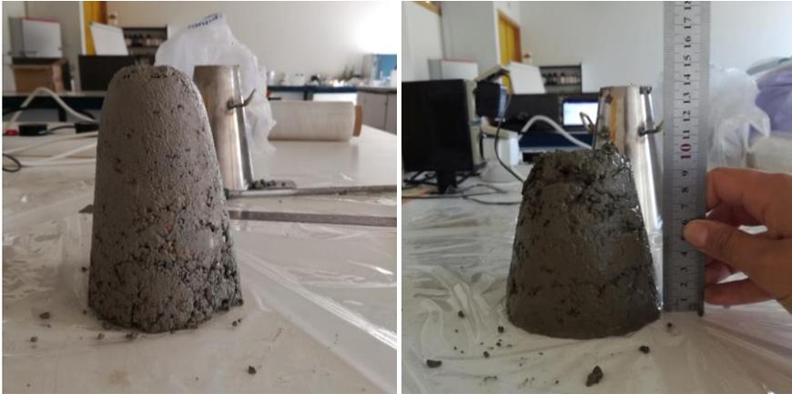
**Figura 5.32 - Mediciones de la altura resultante de la prueba de resistencia**
