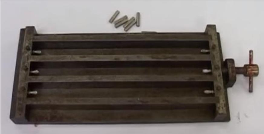
**Figura 5.34 - Molde para ensayos de retracción**
