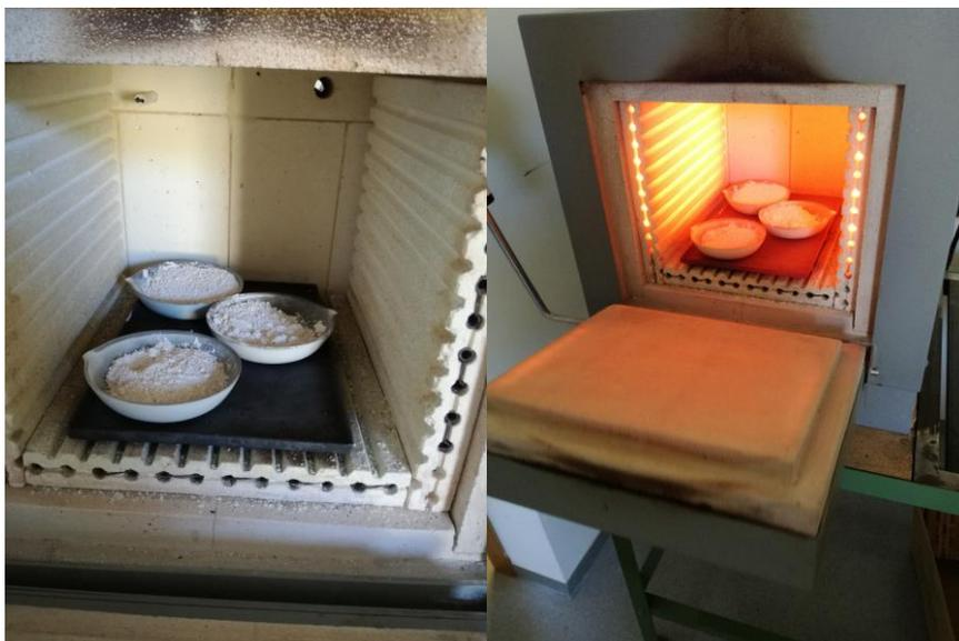
**Figura 5.3 - Calcinación del óxido de magnesio dentro del horno de mufla**
