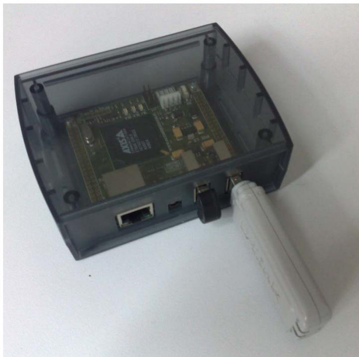
Figura 14. Estación formada por el sistema empotrado Foxboard LX832 y los periféricos USB de Bluetooth y Wifi.
