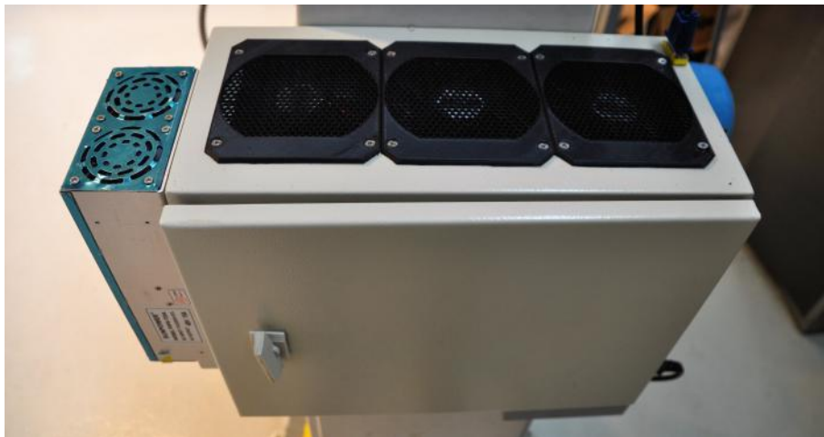
Figura 3.63: Vista superior del armario de control. Detalle de las rejillas de ventilación
