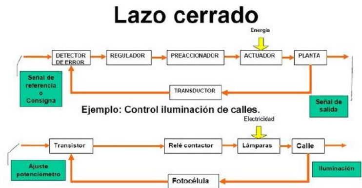
Figura 1.3: Esquema de un control en lazo cerrado
