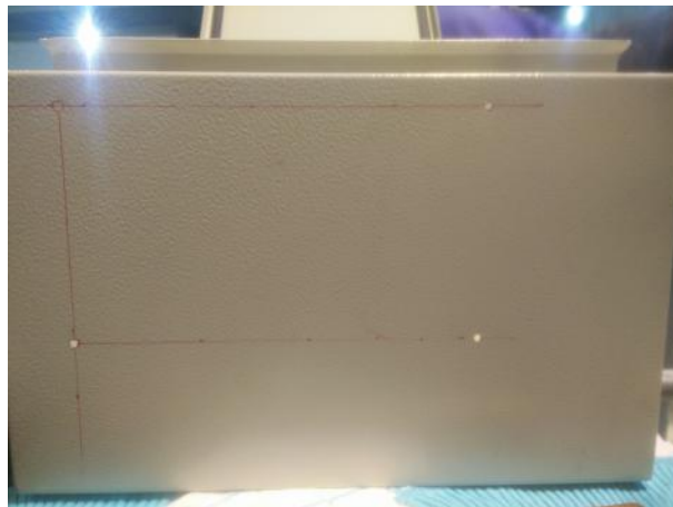
Figura 3.48: Taladros para sujetar fuente de alimentación de los controladores
