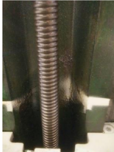
Figura 3.6: Husillo de bolas del eje X de la fresadora Aizpurua T-30-CNC
