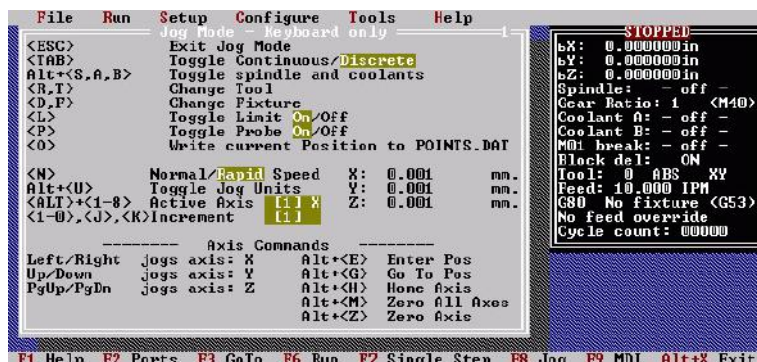
Figura 2.14: Interfaz gráfica TurboCNC
