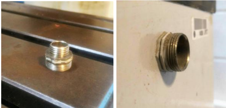
Figura 3.12: Pieza que acopla el tubo a la estructura
