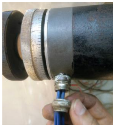
Figura 3.11: Tuerca de unión entre el tubo y el motor
