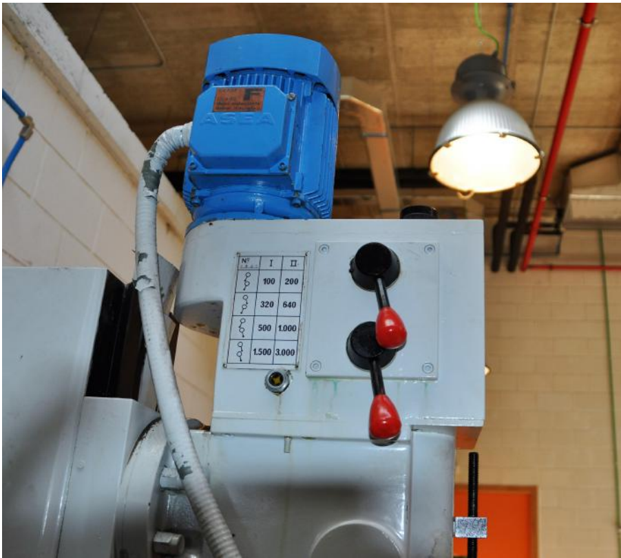
Figura 3.7: Caja de transmisión de la fresadora Aizpurua T-30-CNC
