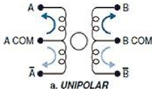
Figura 2.26: Configuración unipolar de las bobinas del estator
