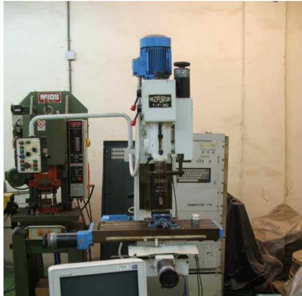
Figura 1.5: Aizpurua-T30-CNC con antiguo sistema de control
