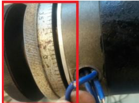
Figura 3.30: Detalle de los cables que salen de las bobinas del motor
