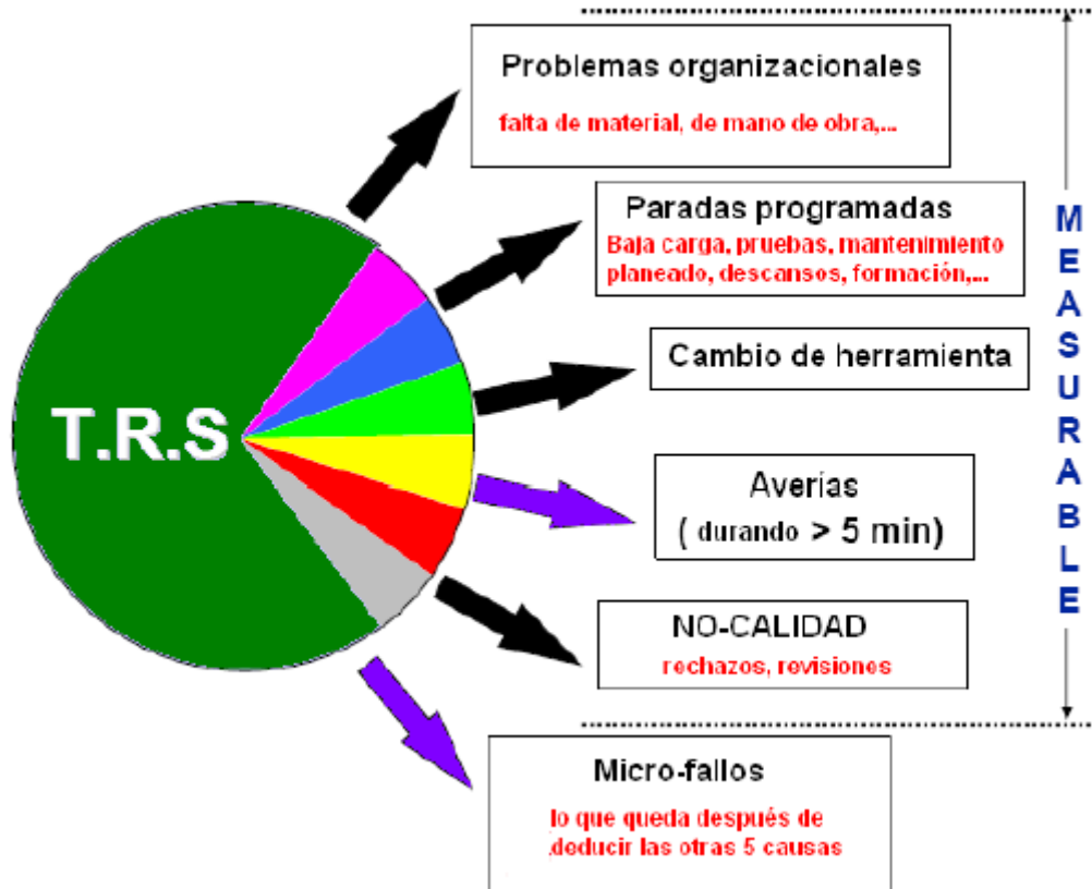
Ilustración 5.23: Elementos que fijan el TRS.
