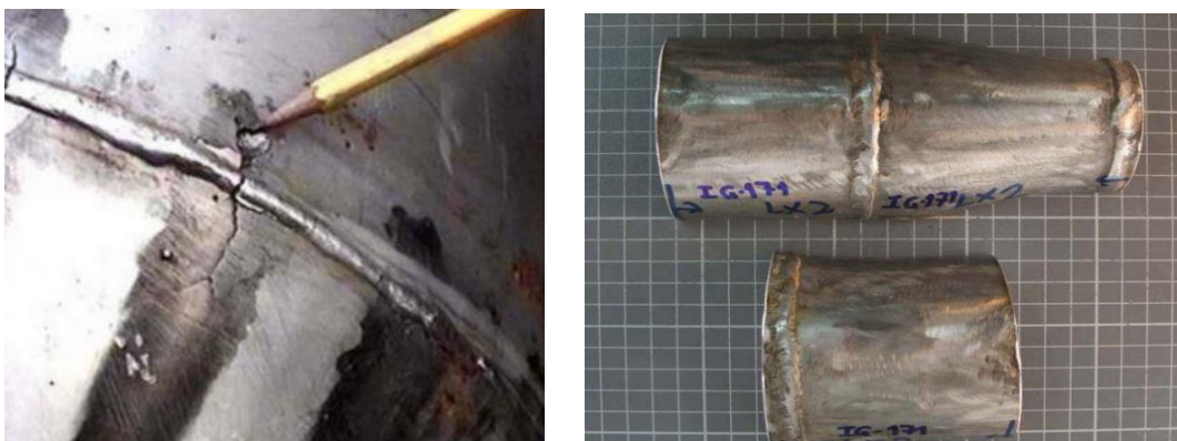
Figura 6. Ejemplos de corrosión bajo tensión
