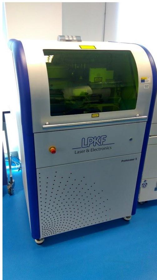
Figura 4.1 Microfresadora láser LPKF Protolaser S.
