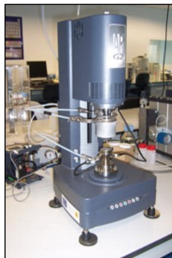
Figura 19. Reómetro AR-G2.
