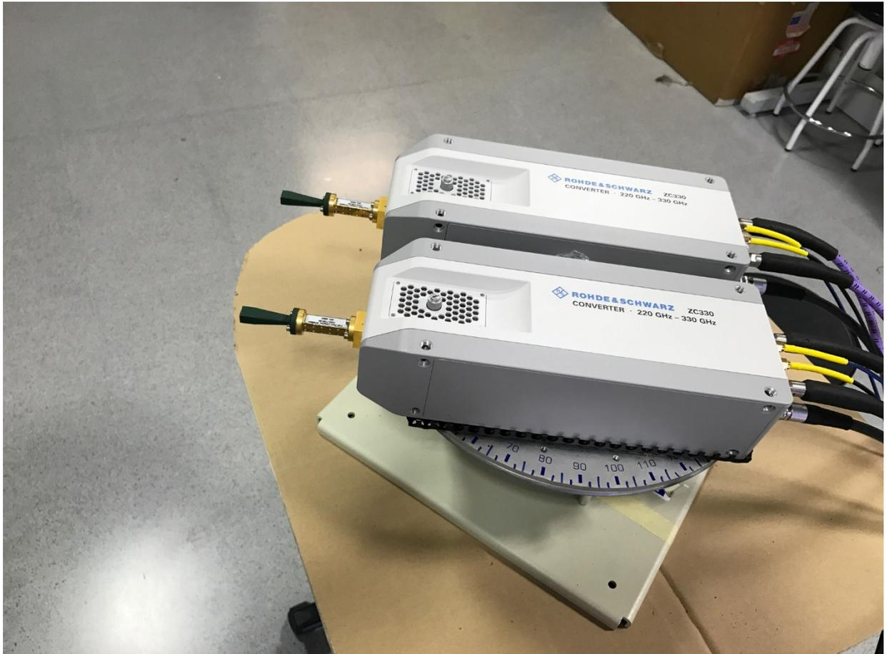
*Figura 4.6. Bocina transmisora y receptora utilizada en el montaje de la campaña de medidas. Se puede apreciar su conexión a las cabezas extensoras de frecuencia, y el pequeño tamaño de las mismas en comparación. El modelo aquí visible es el 32240-25, usado para las medidas a 300 GHz [4]*
