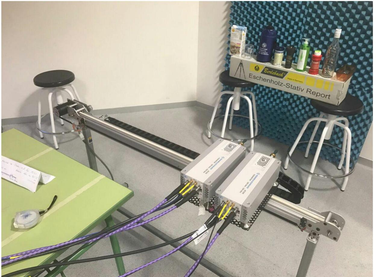
*Figura 4.11. Montaje para las mediciones sobre elementos de forma variada. Se puede apreciar que la gran mayoría son cilindros, aunque también hay un cartón de leche a la izquierda que actúa como forma rectangular.*
