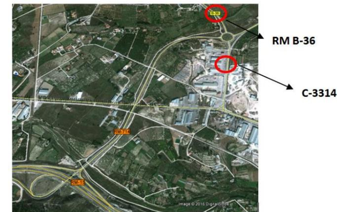
Hasta el PK 1+000 la autovía sigue el mismo trazado de la carretera RM-714, realizando el desdoblamiento por la derecha y utilizando la calzada actual como calzada izquierda. donde coincide la rasante actual con la proyectada.
