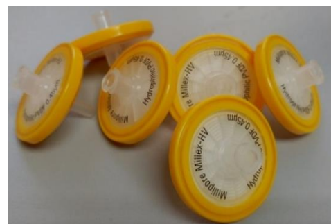
Fig.19. Filtros, retención de los microplásticos.
