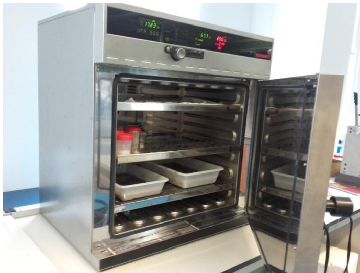
Foto 12 Bandeja porta-muestras en el horno (estufa) donde se han secado las muestras de lodos a 60°C
