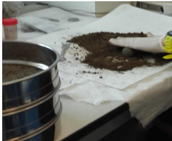
Foto 10 Disgregación de la muestra de lodos en el laboratorio.
