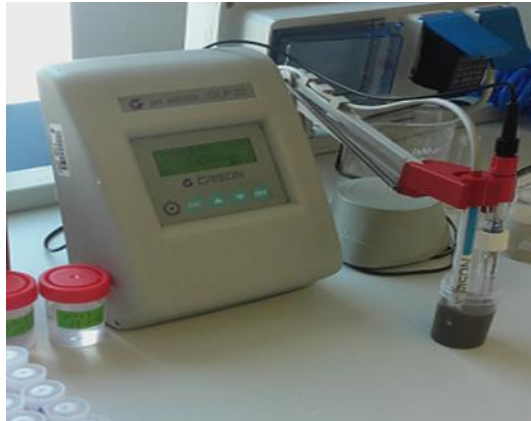
Foto 14 pH metro analizando la muestra de lodos Peña del Águila
