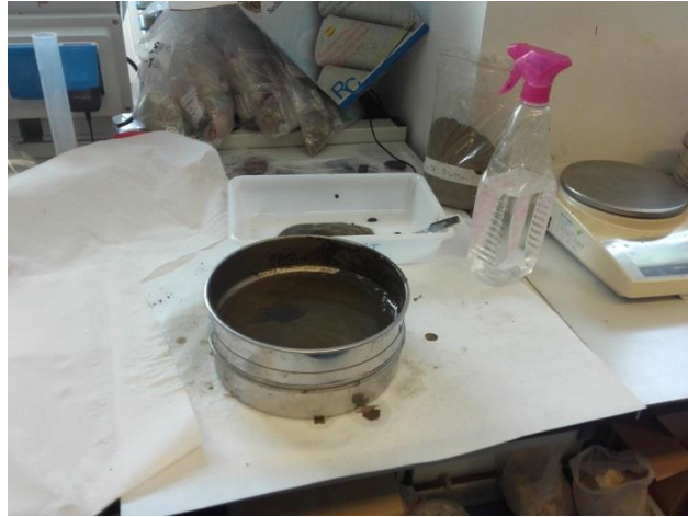
Foto 11 Tamizado en húmedo de la muestra de lodos
