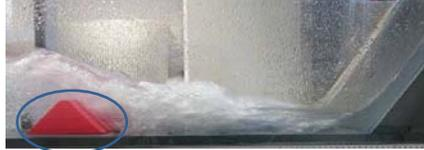
Fig. 7. Ensayo realizado con la pieza Lyapin de 6 cm de altura.
