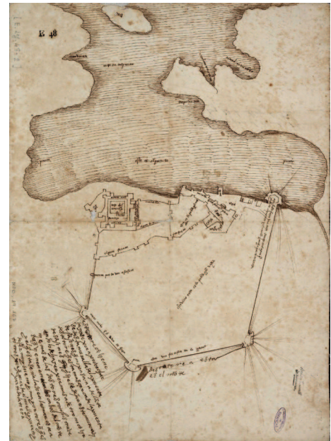
[FIG. 1]. PLANO DEL RECINTO FORTIFICADO DE LA CIUDAD DE CARTAGENA Y TRAZA DE NUEVO MURO QUE DEBÍA CONSTRUIRSE PARA ASEGURAR ESTA PLAZA. AGS MPD 19, 167. FERNANDO DE LAS MADERAS, ANDRÉS DÁVALOS. CARTAGENA, 1541. HTTP://WWW.PORTALCULTURA.MDE.ES/CULTURAL/ARCHIVOS/
