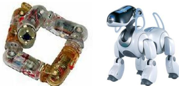
*Ilustración 7. Robots zoomórficos: el primero reptante, el segundo robot mascota [1]*
