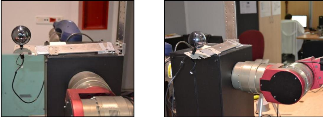
*Ilustración 45. Disposición de la cámara en modo Eye-to-Hand*
