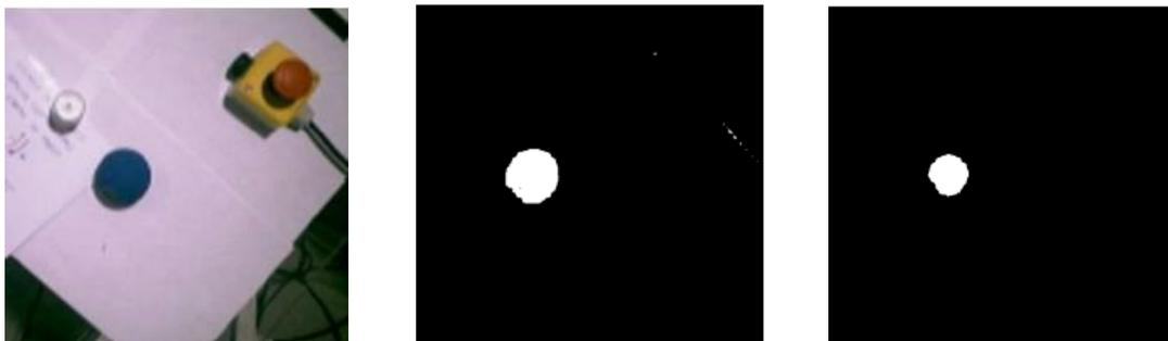
Ilustración 35. Ejemplo de erosión. Imagen original (izq), imagen umbralizada (cen) e imagen erosionada (der)
