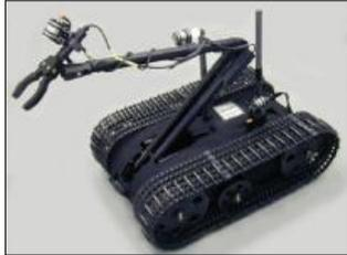
*Ilustración 5. Robot móvil usado en la desactivación de minas [1]*
