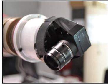
Ilustración 40. Disposición de la cámara uEye en modo Eye-in-Hand
