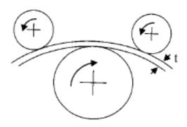
El depósito se cierra por los extremos con dos tapas toriesféricas conformadas por entalla prensándolas con rodillos en frio , sus dimensiones aparecen en **1.4.1.3.1**.
