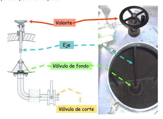
La válvula de fondo que vamos a utilizar en el depósito es de la marca EQUIPTANK de 3",llevará sus respectivas bridas que aseguran su estanqueidad.
