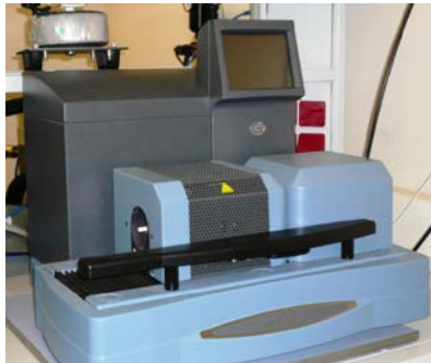
Imagen 3.2. Aparato en el cual se realizan los ensayos termo gravimétricos.
