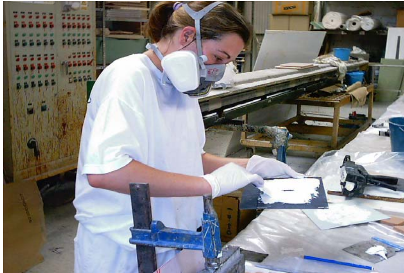
Figura 9: Aplicación del adhesivo sobre el substrato flexible.
