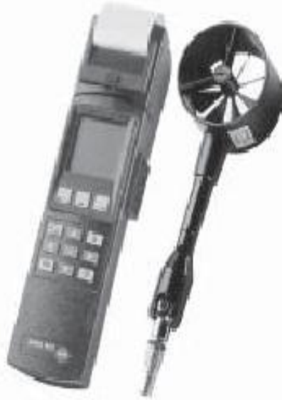
Figura 3.6: Velómetro o Anemómetro de Molinete
