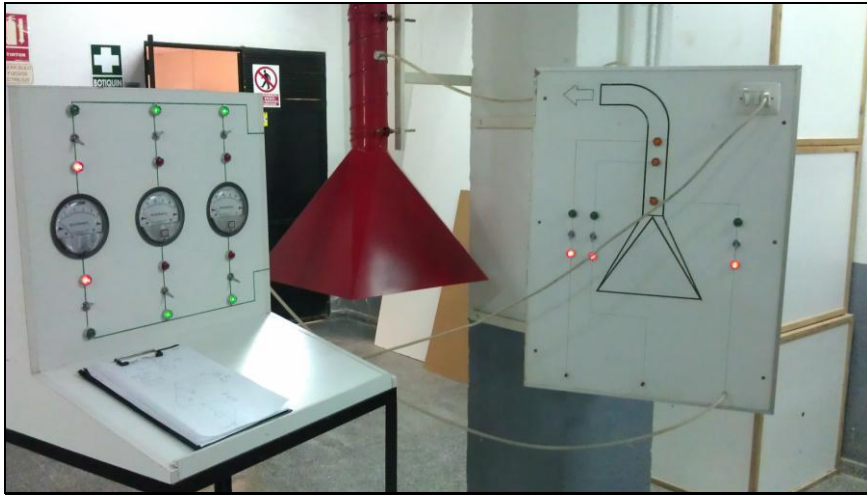
Foto 7.8 Panel de control y Punto 1 Extracción Localiza
