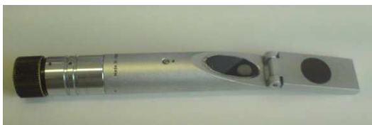
Figura 3.3. Refractómetro de mano modelo Zeiss Opton (Jana, Alemania).
