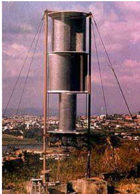
Figura 3. Aerogenerador Savonius
