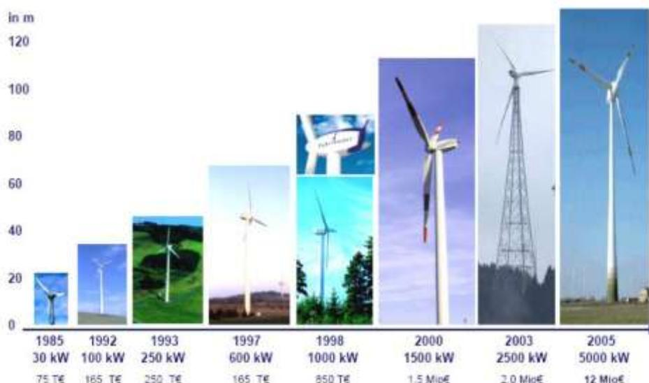
Figura 6. Evolución de los aerogeneradores, periodo 1985-2005.
