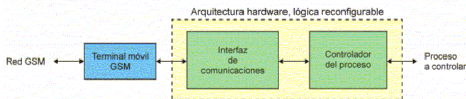
Fig. 2. Estructura general de la arquitectura hardware diseñada.
