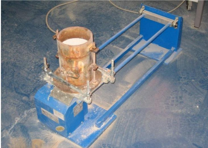
**Figura 22:** Compactadora automática de morteros
