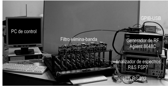
Figura 3. Montaje experimental del sistema de medida completo.
