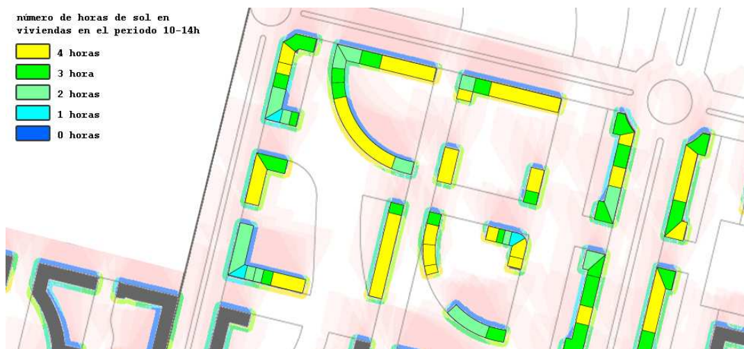
Fig. 31. Detalle de número de horas de sol en viviendas el 21 de diciembre en el periodo 10-14h. Fuente: Elaboración propia.
