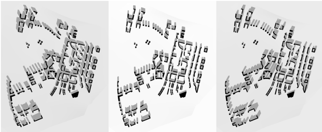
Fig. 12. Ejemplo de bitmaps obtenidos del software CAD con las sombras de la edificación existente el 21 de diciembre a las 10 (izquierda), las 12 (centro) y las 14 (derecha) horas. Fuente: Elaboración propia.
