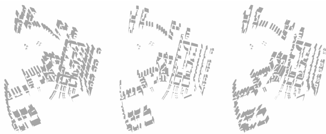
Fig. 14. Ejemplo de bitmaps obtenidos tras selección de las sombras para el 21 de diciembre a las 10 (izquierda), las 12 (centro) y las 14 (derecha) horas. Fuente: Elaboración propia.
