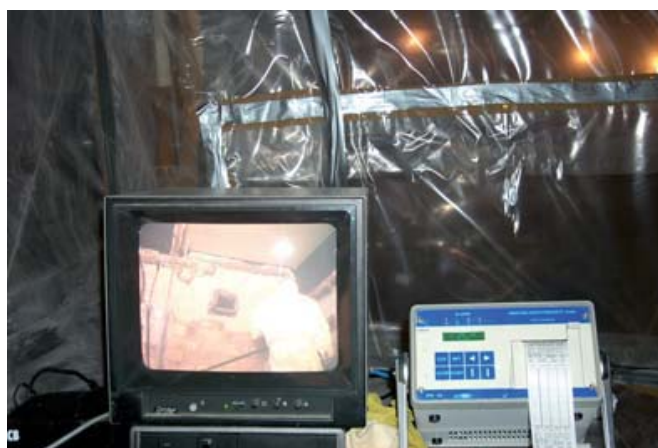
Figura A3.11 Medidas adicionales para el control de la eficacia burbuja
