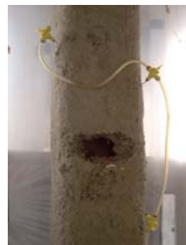
Figura A3. 16 a Figura A3. 16 b Sistema de humectación por inyección, diseñado para humectar materiales friables en profundidad y detalle de aplicación
