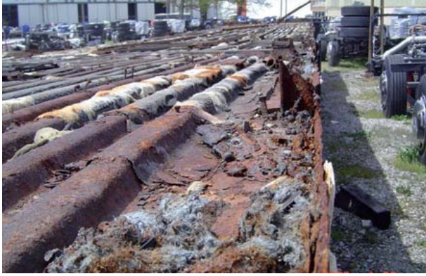
Figura A3.26a Residuos incontrolados de crocidolita retirados de vagones de ferrocarril.
