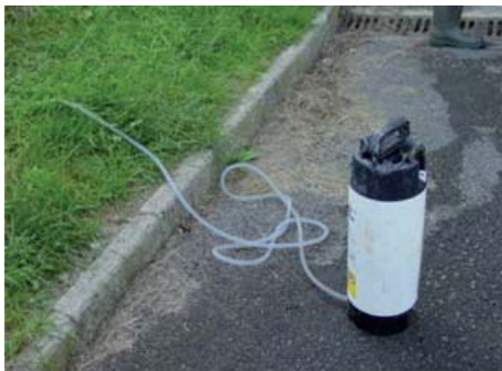
Figura A3.15 Bomba manual de presión y manguera para la humectación de conductos de fibrocemento en trabajos de mantenimiento
