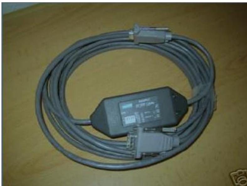
Figura 4.1.1 a) cable de comunicación PC/PPI.
