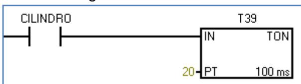
8. Finalizada la temporización se activa CSD, indicador de que el cilindro de doble efecto se encuentra completamente extendido. Esto es equivalente a sensor REED final de carrera.
