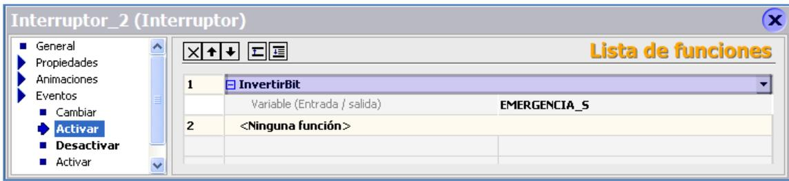
Figura 5.2.7.b) activación de la parada de emergencia en el SCADA
