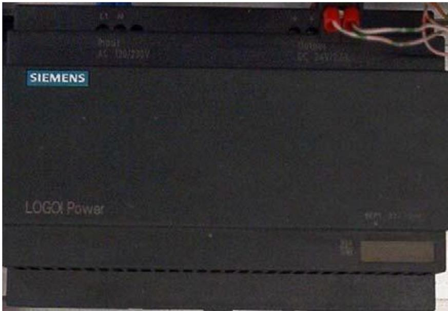
Figura 5.2.2.3: Fuente de alimentación del motor de continua.
