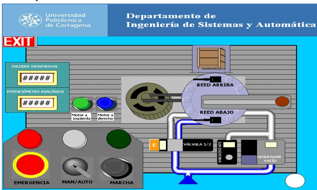
Figura 5.4.7.2: SCADA unidad didáctica Manipulador Electro-neumático.
