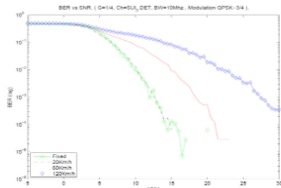
Fig. 2 Gráfico BER vs SNR para canal SUI3.
