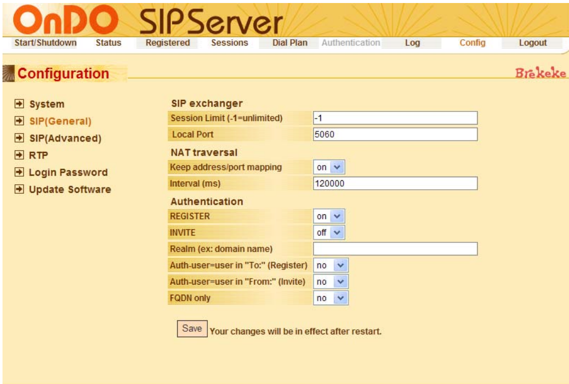
Ilustración 1: Configuración SIP del servidor seleccionada para realizar la autenticación al recibir una petición REGISTER
