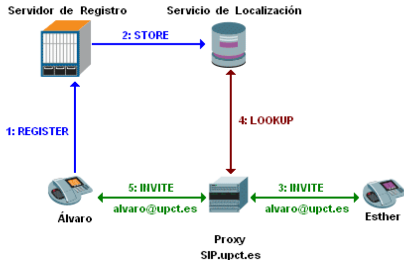
Figura 3-13: Ejemplo de establecimiento de una llamada entre terminales SIP
