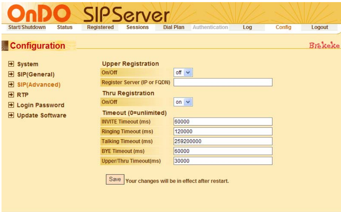
Ilustración 2: Configuración SIP avanzada, se aprecia que el parámetro Thru Registration está habilitado, tarea que se hace automáticamente al instalar el plug-in
