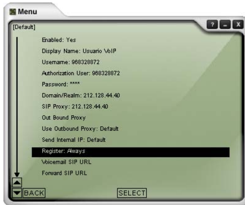
Ilustración 32: Panel de configuración SIP relleno con los parámetros del servicio de telefonía IP de la ETSIT
