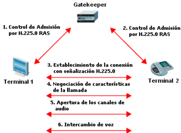
Figura 3-9: Inicio de una conexión entre dos terminales H.323 dentro de la misma red
