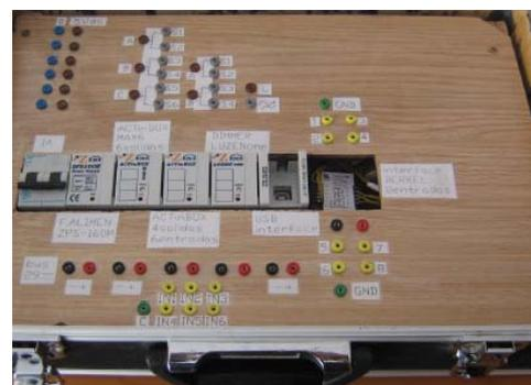
Figura 2: Parte superior e inferior de la maqueta de una vivienda domótica.
