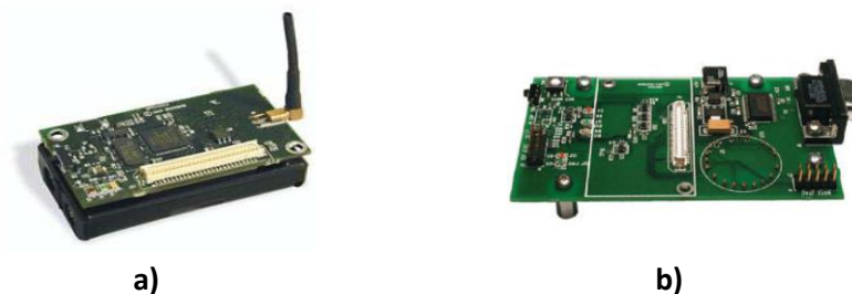
Figura 2-14: (a) Micaz Mote. (b) Placa de desarrollo MIB510.
