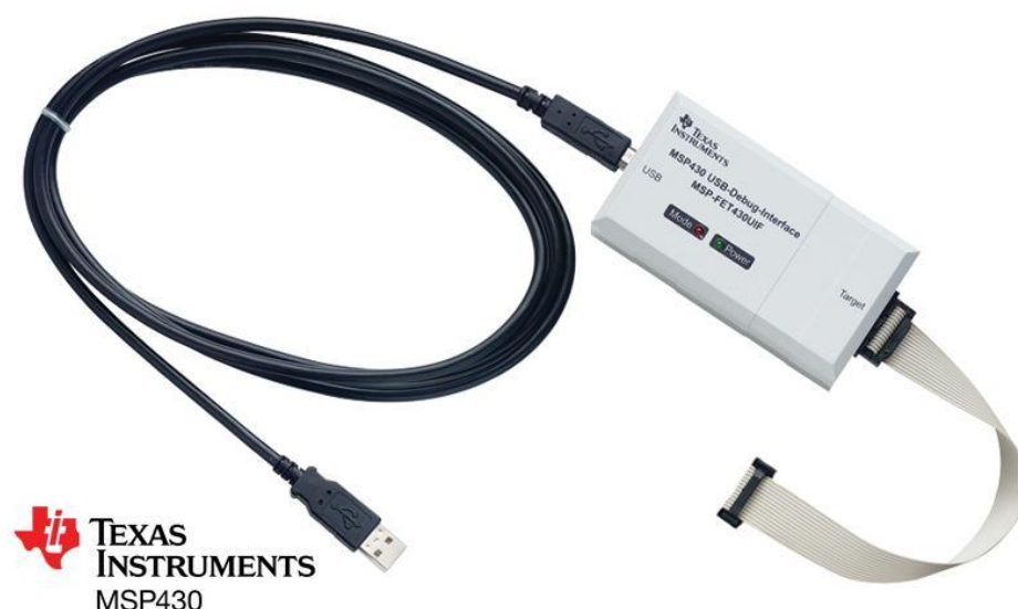
Figura 4-1: Dispositivo para programar el microcontrolador a través del USB, por medio de la interfaz JTAG.
