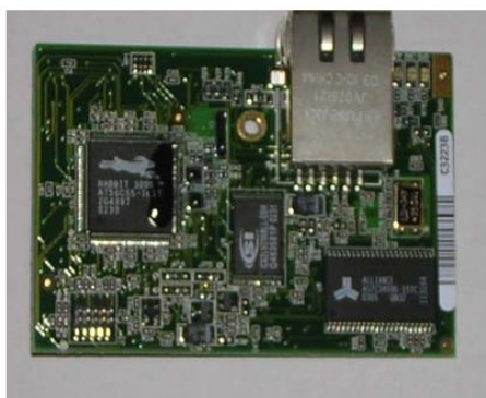
Figura 2-2: Nodo Usado en una red de monitorización de sustancias NBQ[4].
