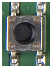
Figura 3-19: Pulsador de reset montado en placa.
