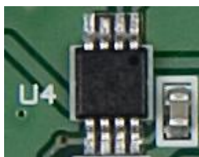
Figura 3-15: Reloj en tiempo real DS1339 montado en placa.
