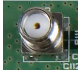
Figura 3-13: Conector de antena montado en placa.
