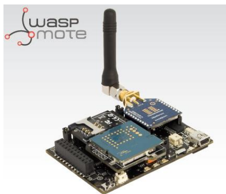
Figura 2-21: Vista en perspectiva del Waspote con módulo de radio, GPS y GPRS incorporados
