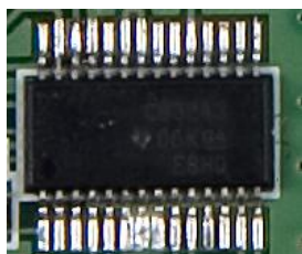
Figura 3-20: Conversor de niveles RS232 montado en placa.
