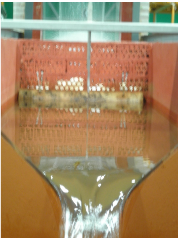
Figura 3.3. Vertedero triangular desaguando, con limnómetro al fondo.
