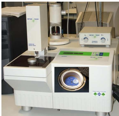
Figura 3.9. Calorímetro con detalle del horno.
