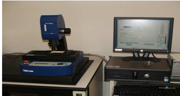
Figura 3.14. Perfilómetro de no contacto focal.
