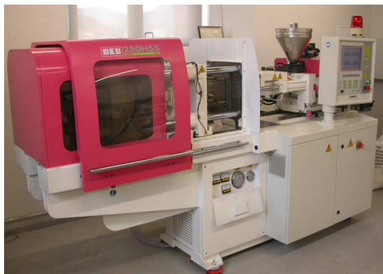
Figura 3.5. Máquina de inyección DEU 250 H55 mini VP.
