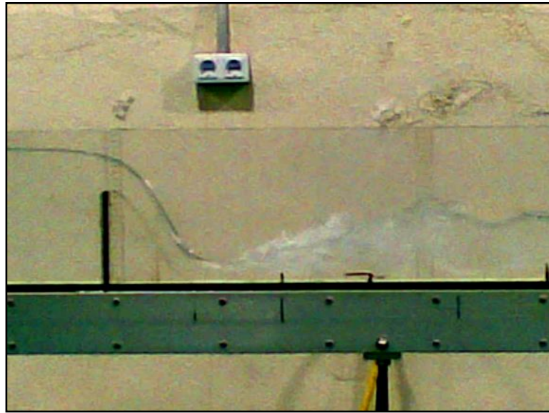
Figura 3.10. Resalto libre formado al pie del aliviadero.
