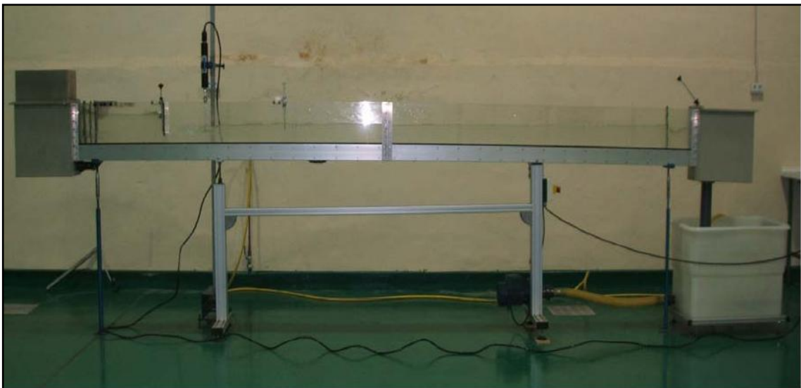
Figura 3.1. Canal de laboratorio (Márquez, 2006).
